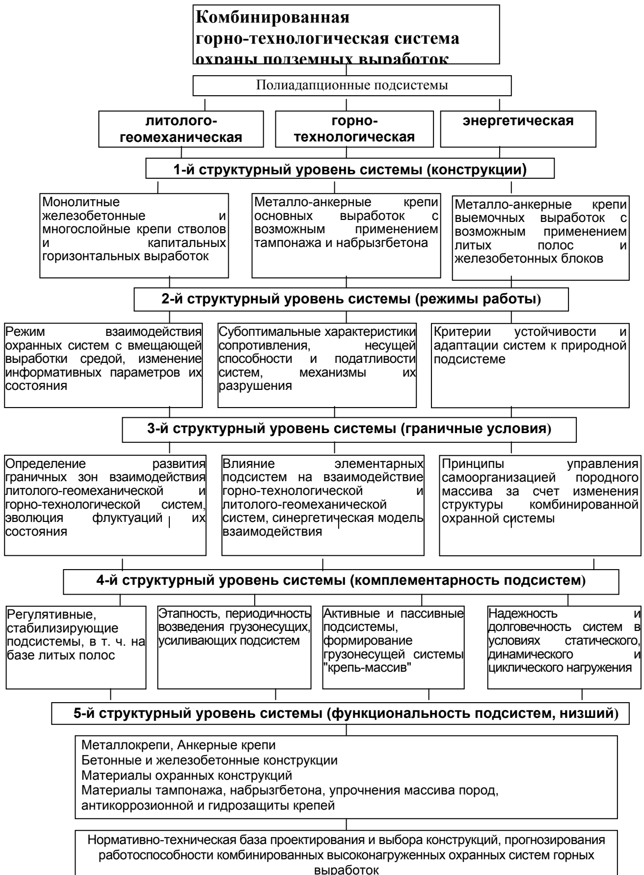
Рис. 2 – Схема структурного анализа комбинированных охранных систем горных выработок
